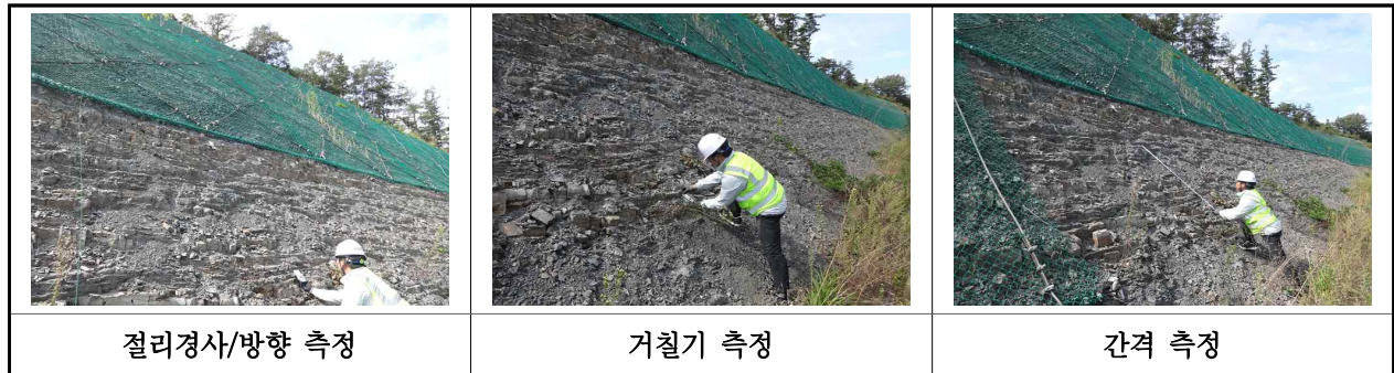
【그림 59.3.5】 불연속면 측정 현황
